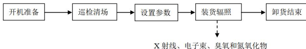
图 2-6 辐照加工的工艺流程及产污环节示意图
